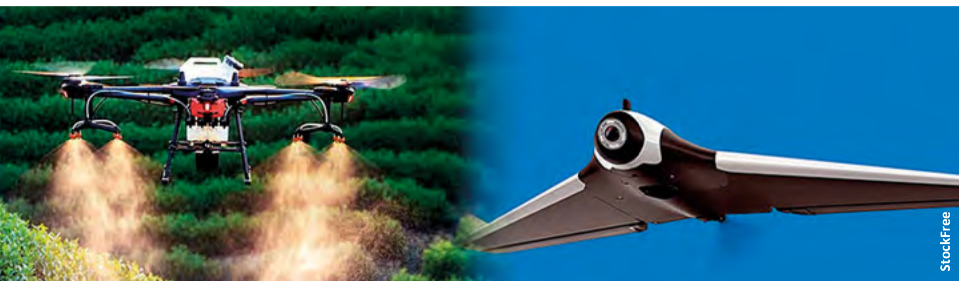
Os dois tipos de drones utilizados na agricultura: multi-rotor (esq.) e asa fixa.
